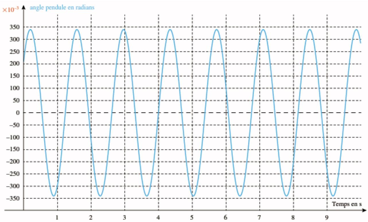
2. Par lecture graphique, déterminer : l'amplitude  $\theta_m$ , la période  $T_0$ , la fréquence  $f_0$ , la pulsation  $\omega_0$ , la phase à l'origine  $\varphi$  du mouvement du pendule simple. Comparer avec la théorie :
